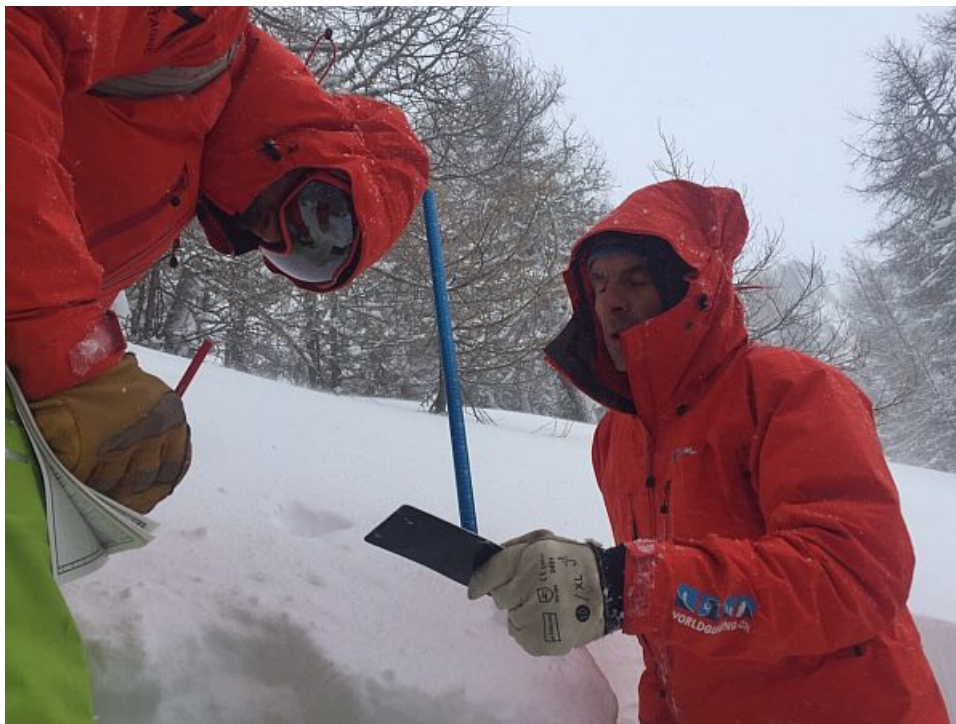
Abb. 5: SLF Beobachter beim Profilen. Der Rutschblock brach innerhalb des Neuschnees bei Stufe 2 (beim sorgfältigen Betreten des Rutschblockes durch einen Skifahrer). Nordwesthang auf 2000 m (Foto und Video: J.-L. Lugon, 11.01.2016).
