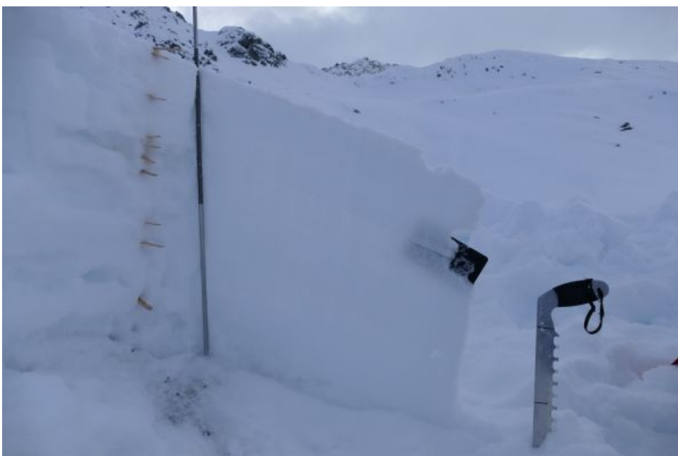
Im durchscheinenden Profil kommt ein Oberflächenreif zu Tage. Allerdings zeigt der ECT (Extended column test) keine Bruchausbreitung in dieser Schicht (Foto: SLF/J. Wessels, 10.01.2015).
