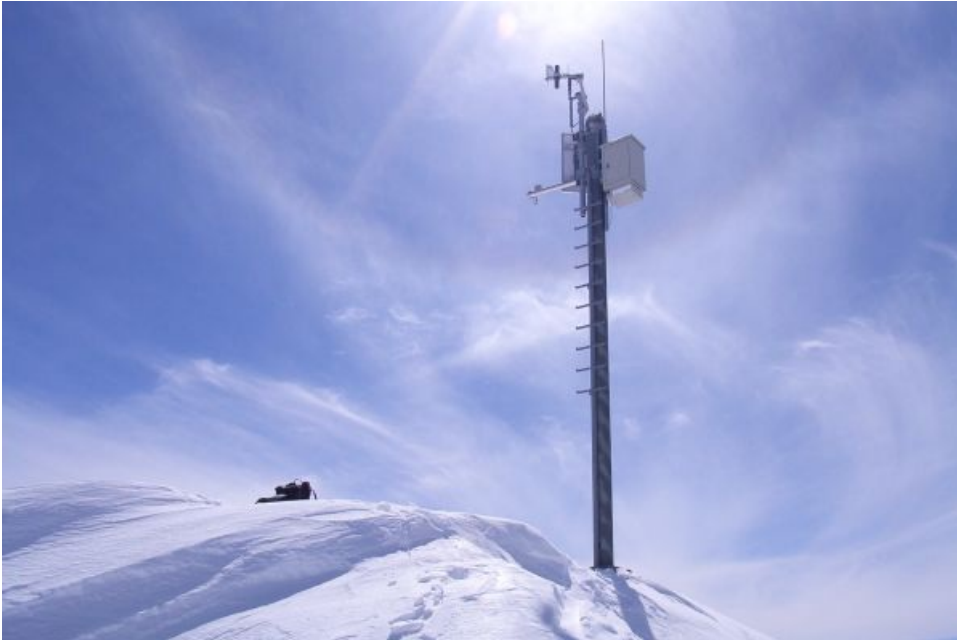
Die Windstation des IMIS-Messnetzes auf dem P. Pian Grand (3689 m) (GR) liefert wertvolle Information für die Lawinenwarnung (Foto: P. Vivalda, 03.04.2013).
