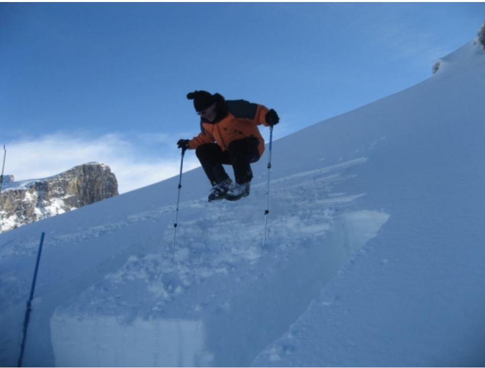
Bei diesem Rutschblock in einem Nordhang auf 2030 m im Lidernengebiet war auch mit "grossen Sprüngen" nichts auszulösen. (Foto: X. Holdener, 15.01.2011).
