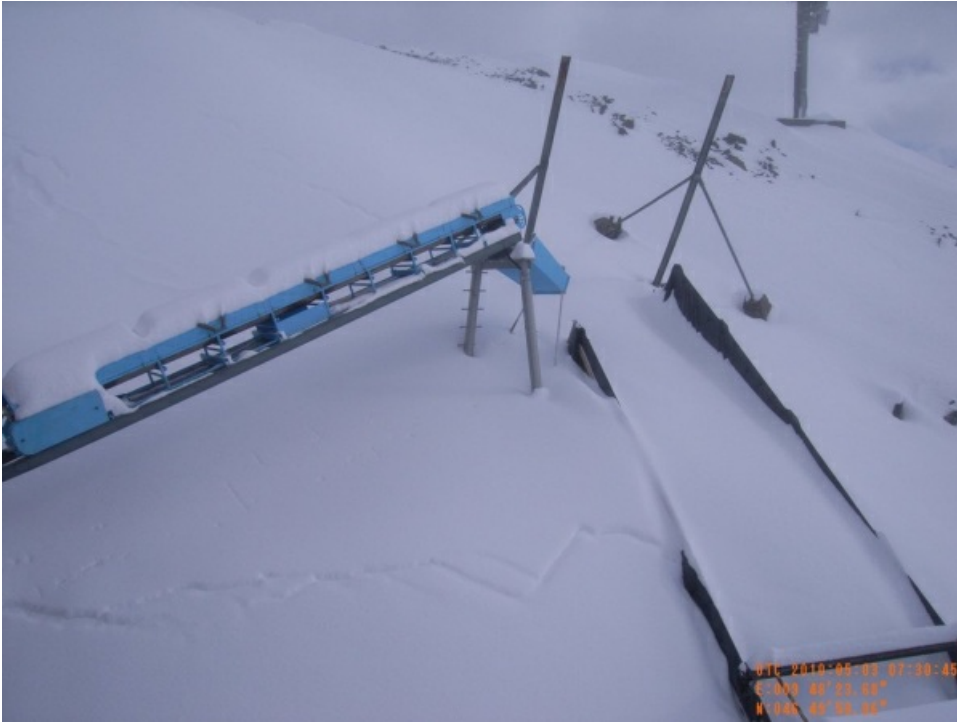
Der Neuschnee der vergangenen Nacht war meist zu schwer für die nasse und weiche Altschneedecke. Es lösten sich etliche spontane Lawinen oder es entstanden Risse in der Schneedecke, wie auf dem Bild sichtbar. Lawinengleitbahn auf dem Weissfluhjoch, Davos, GR (Foto: SLF/R. Meister, 03.05.2010).
