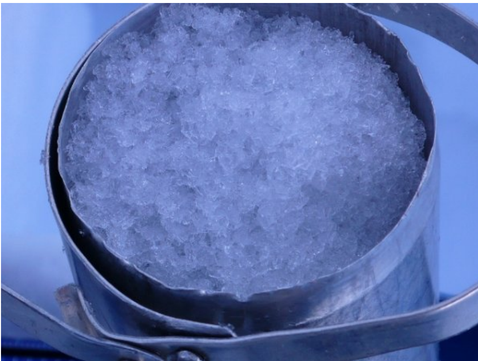
In tiefen Schichten der Schneedecke finden sich immer noch kantig aufgebaute und grobkörnige Schneeschichten, dies besonders in Höhenlagen zwischen rund 2200 und 2800 m. Das Bild zeigt eine Probe solcher Kristalle anlässlich einer Profilaufnahme am La Veudale, 2580 m, Trient, VS (Foto: J.-L. Lugon, 14.04.2010).
